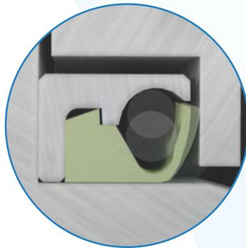
Bei hoher Drehzahl (10000RPM) hebt die Dichtlippe ab
